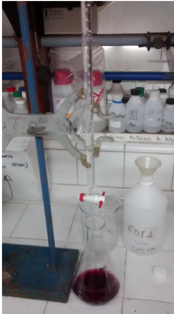
Figura 3.2.2.3.d: Titulación para la determinación de la dureza.
