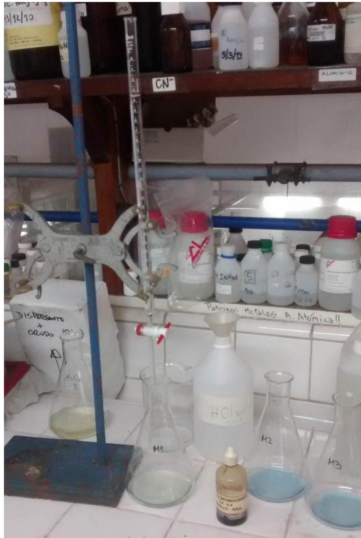
Figura 3.2.2.3.c: Titulación para la determinación de la alcalinidad.
