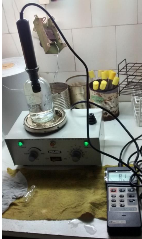
Figura 3.2.2.3.a: Medida del oxígeno disuelto para la DBO 5 .
