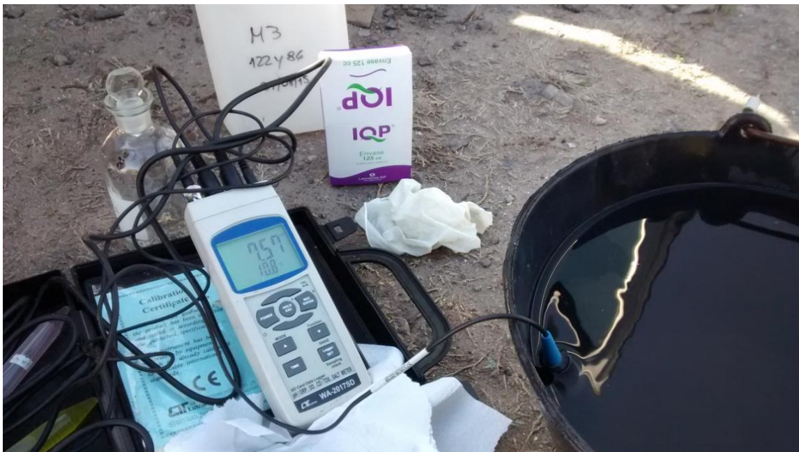
Figura 3.2.2.1.a: Medición de parámetros fisicoquímicos in situ .
