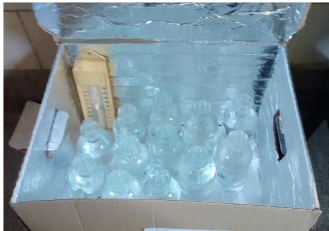
Figura 3.2.2.3.b: Incubación de las muestras para la DBO 5 .
